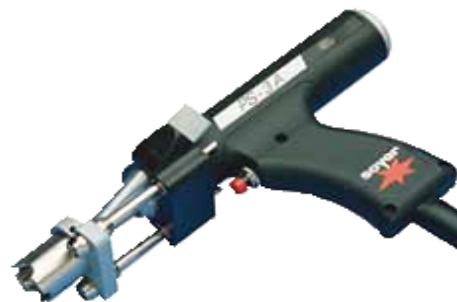
PS-3A típusú automata csaphegesztő pisztoly
